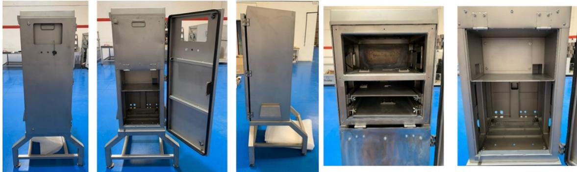
**Figura 17.** Chasis del prototipo tras su construcción por METASOL en las instalaciones de NOVADEP. Vista frontal cerrado, frontal puerta abierta con zona blindada cerrada, vista lateral, detalle zona blindada abierta y detalle zona media e inferior.
