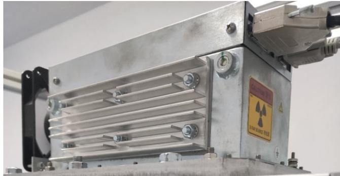
Figura 9. Tubo de rayos X microfoco de HAMAMATSU (80 kV, 50 W, 30  $\mu$ m).
